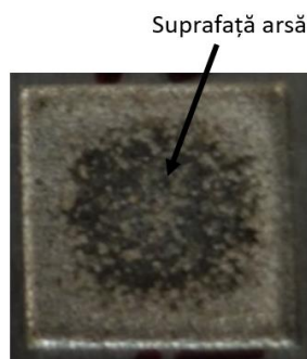
Figura 4.6 Reprezentarea suprafeței erodate cu depuneri de material ars (C120)
