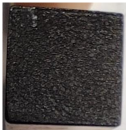
Figura 4.9 Suprafața frontală a electrodului de Cu 99.9 cu depuneri
