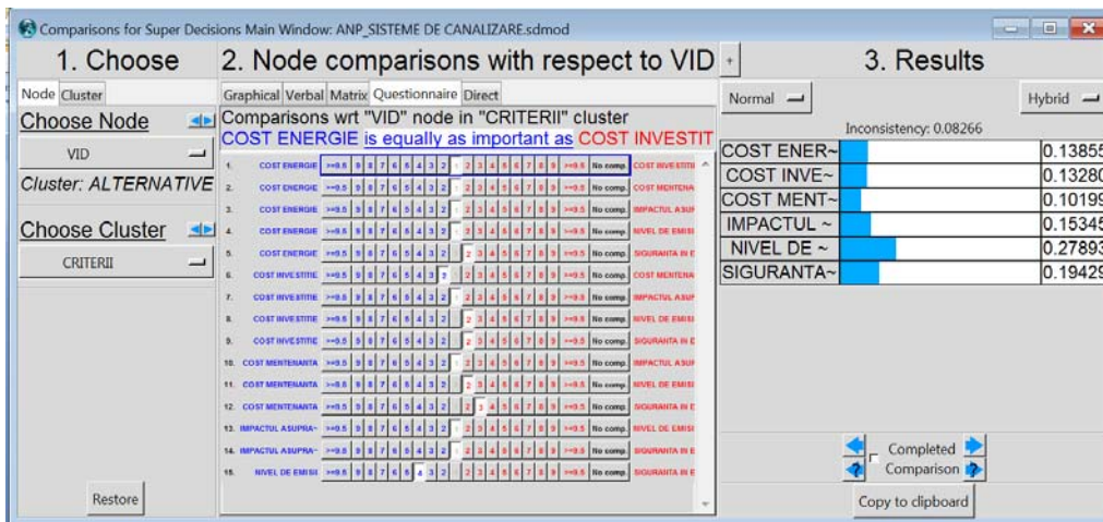
Figura 11-2. Compararea nodurilor cu referire la sistemul colectare a apei uzate sub vid
