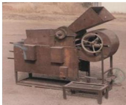
Fig. 2.34. Separator în curenți de aer înclinați [127].
