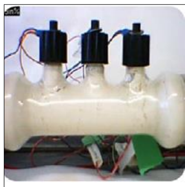
Figura 4.6 Celula electrocinetică (t = 36 h)
