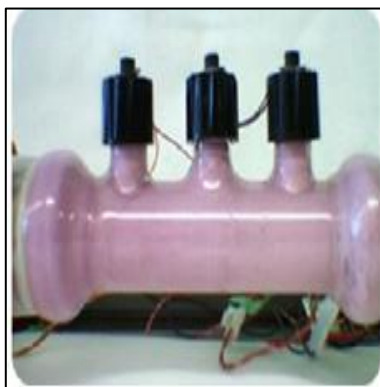
Figura 4.1 Celula electrocinetică (t = inițial)
