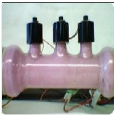
Figura 4.2 Celula electrocinetică (t = final 48 h)
