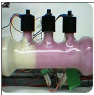
Figura 4.4 Celula electrocinetică (t = 12 h)
