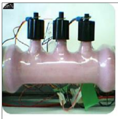
Figura 4.3 Celula electrocinetică (t = inițial)
