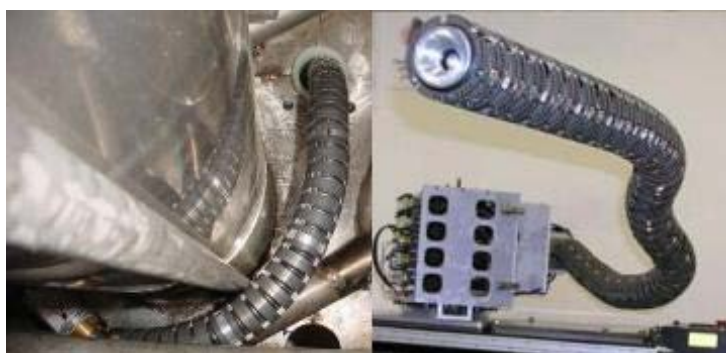
Fig.1.29. Braț robotic pentru inspecții tehnice de la OC Robotics [129]
